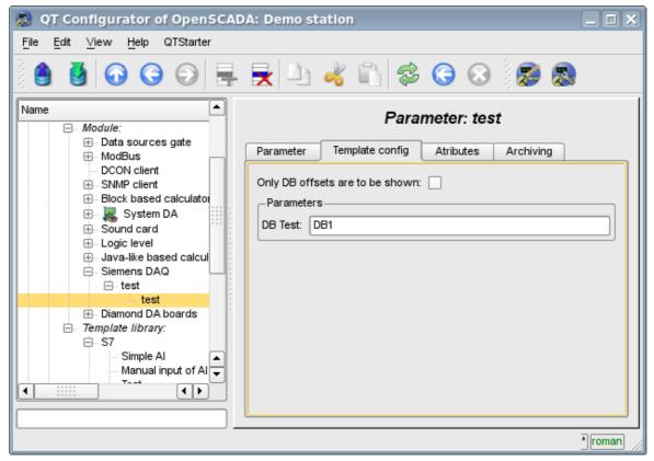
Fig.6. Configuration tab of the template of parameter
