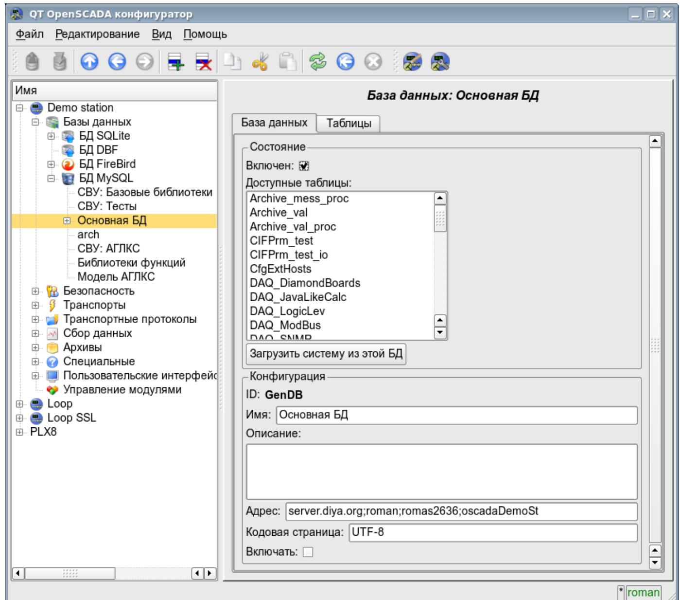
Рис. 18. Вкладка 'База данных' БД модуля подсистемы 'БД'.
