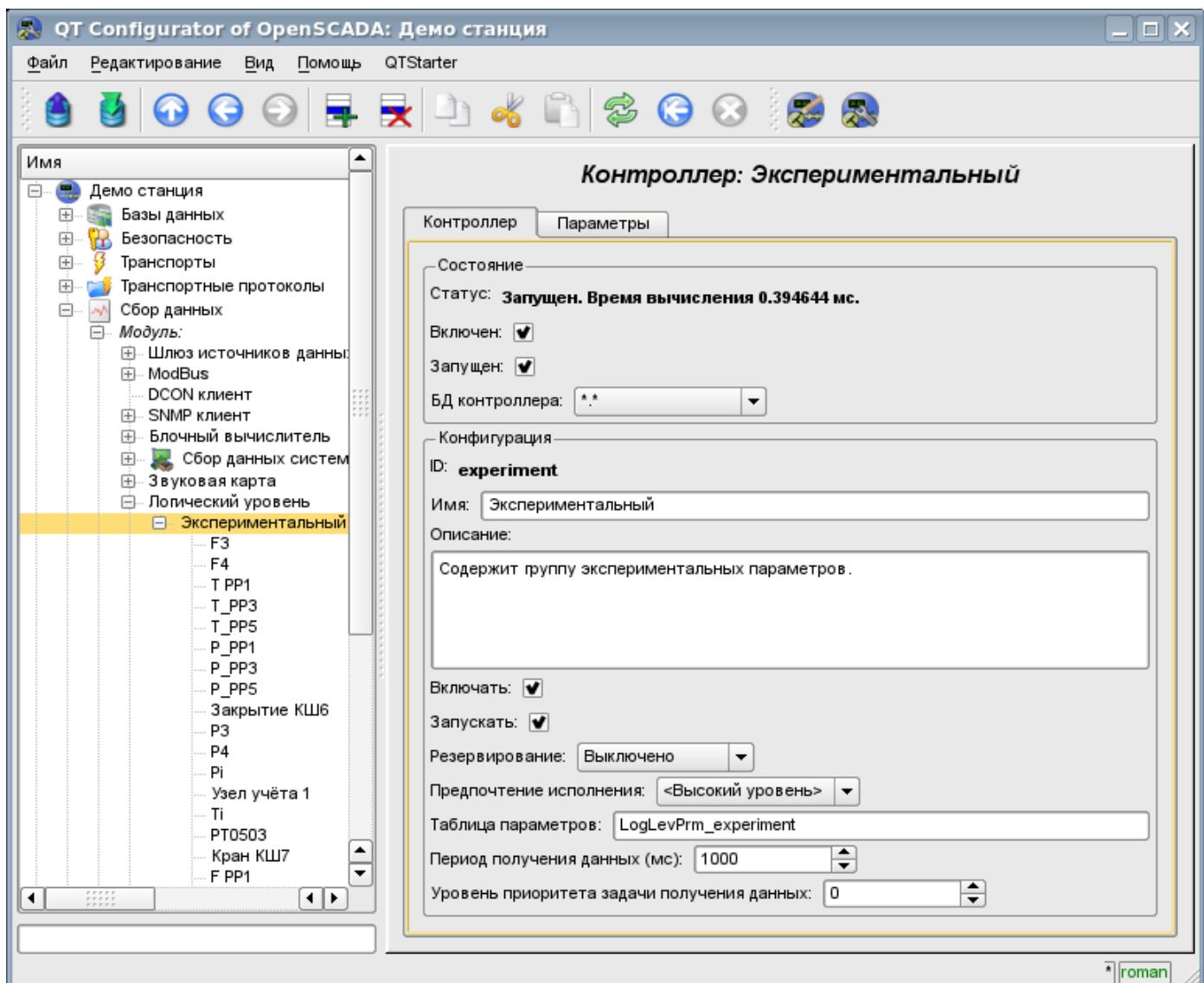
Рис. 38. Главная вкладка конфигурации контроллера подсистемы 'Сбор данных'.
