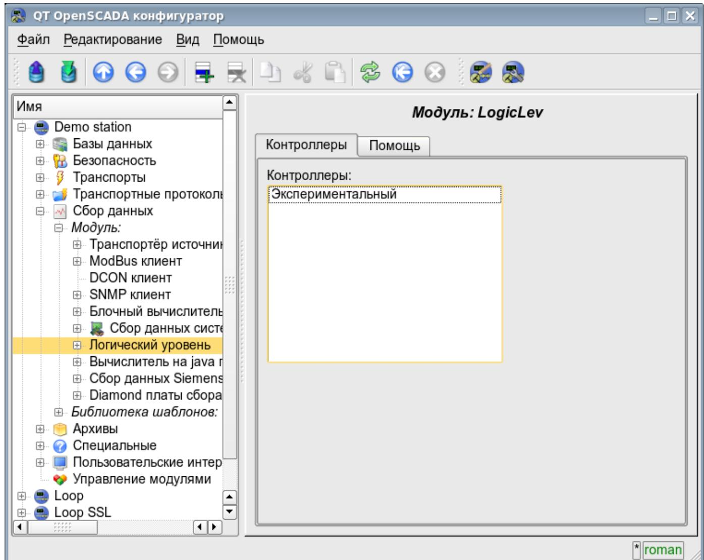
Рис. 37. Вкладка 'Контроллеры' модуля подсистемы 'Сбор данных'.
