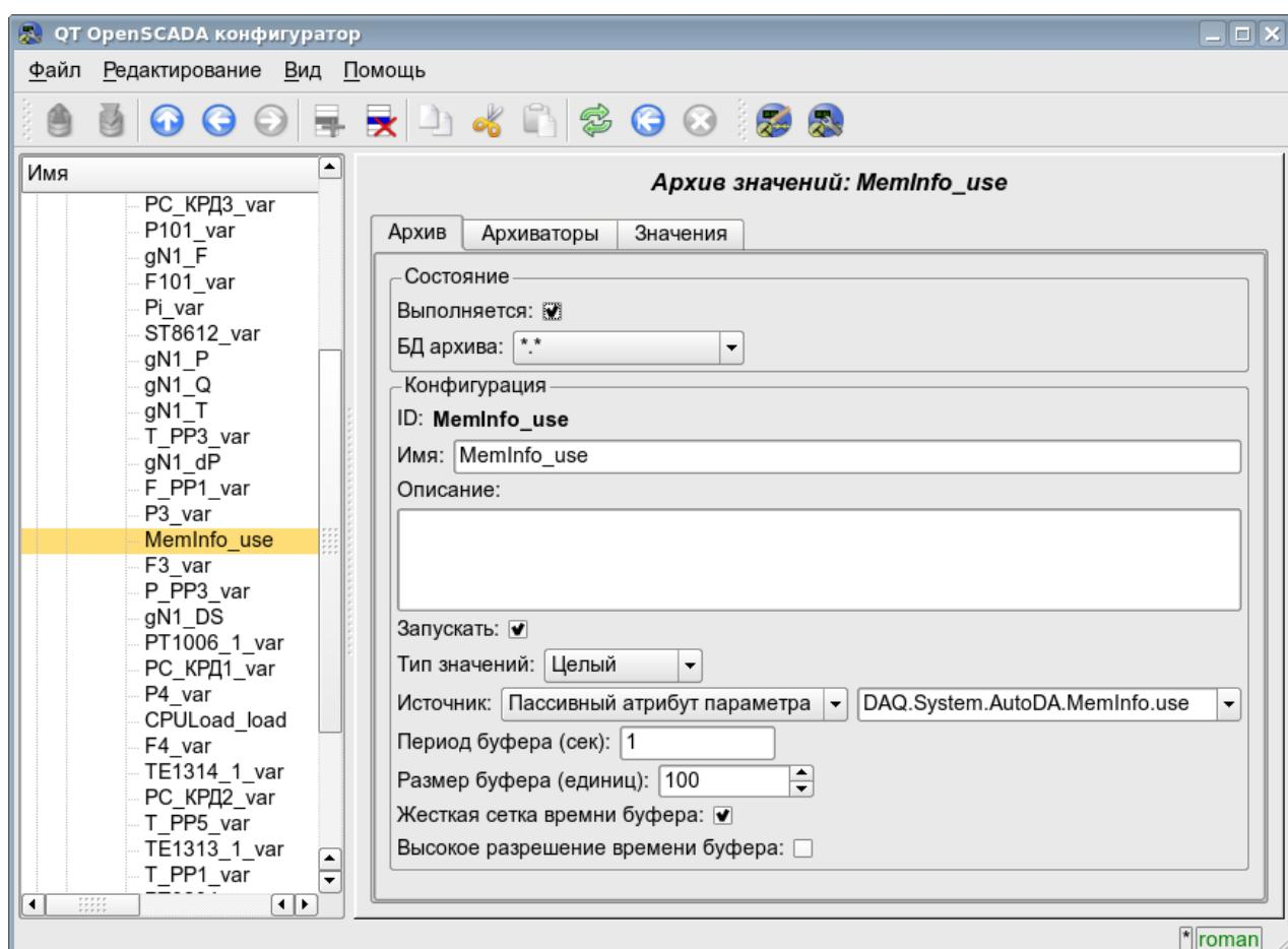
Рис. 47. Основная вкладка конфигурации архива значений подсистемы 'Архивы'.
