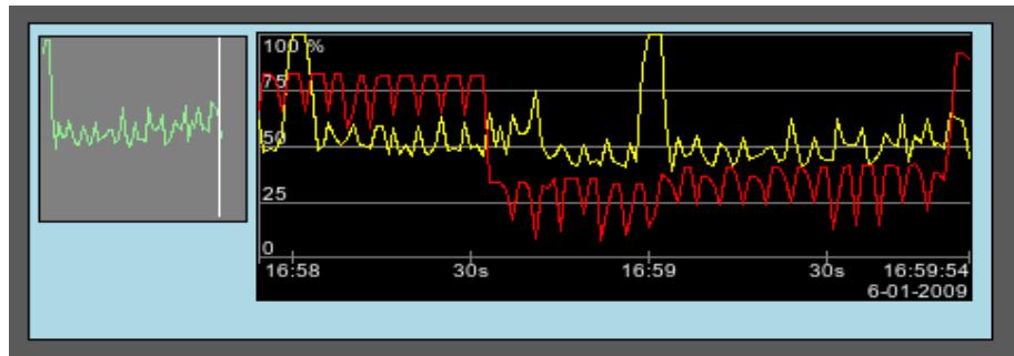
Рис.13. Реализация базового элемента отображения диаграммы-тренда в Vision.
