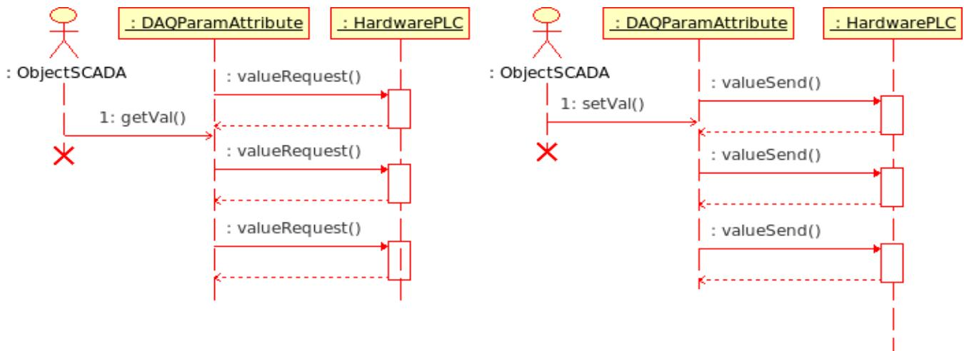
Рис. 3. Диаграмма последовательности взаимодействия при асинхронных запросах.
