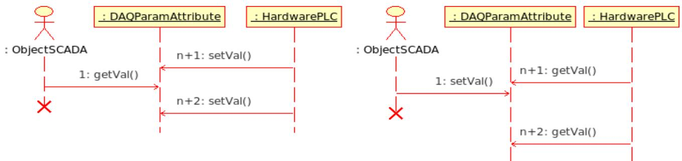
Рис. 5. Диаграмма последовательности взаимодействия при пассивном механизме работы.
