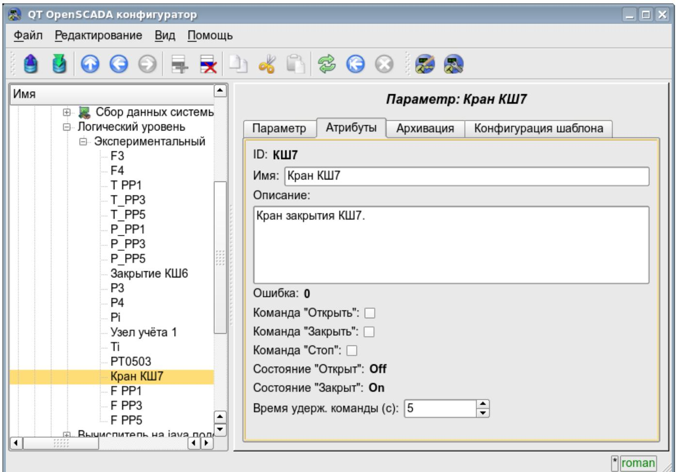
Рис. 41. Вкладка 'Атрибуты' параметра контроллера подсистемы 'Сбор данных'.
