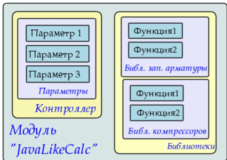
Рис. 6. Общая структура компонентов среды программирования
