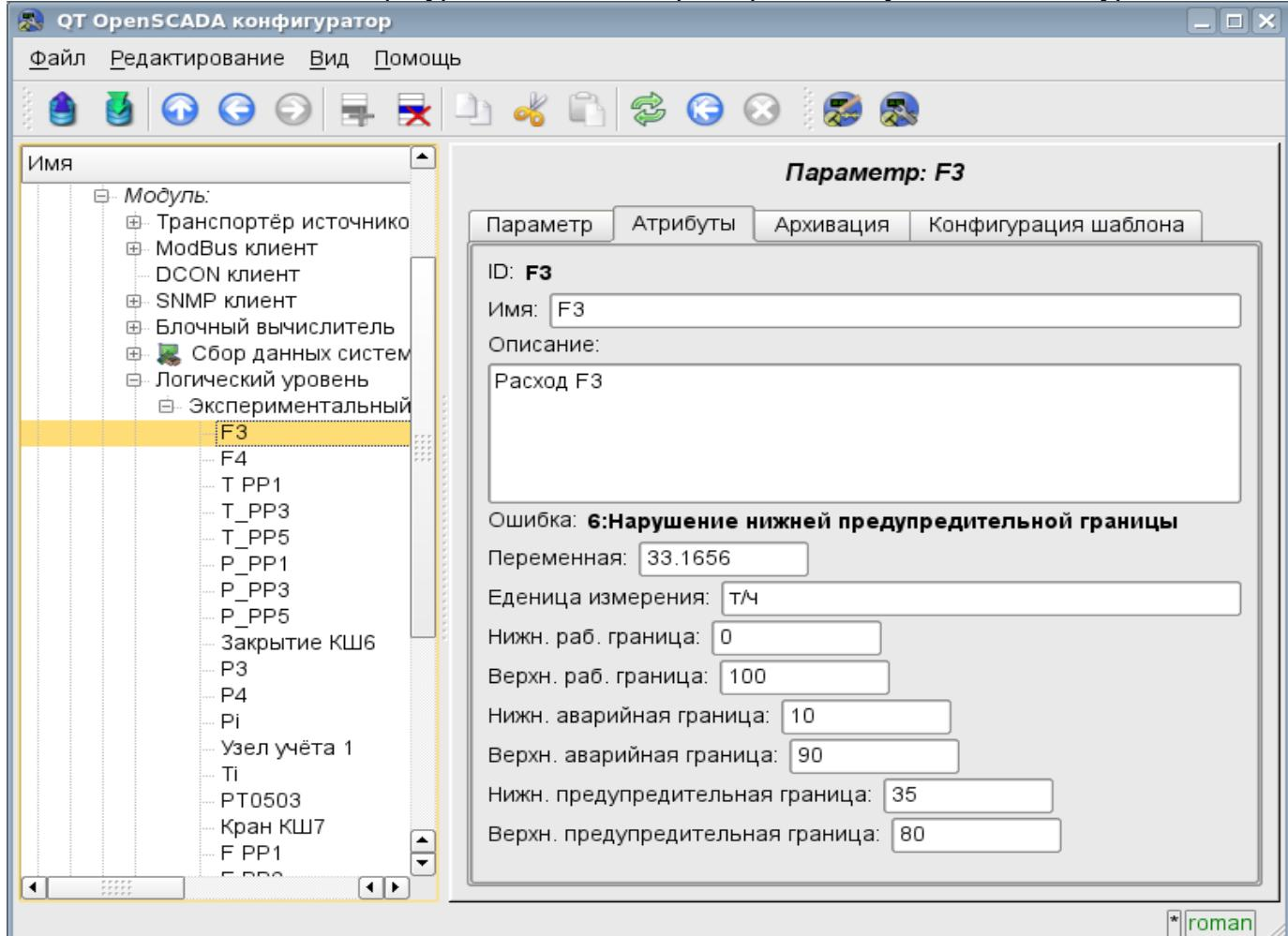
Рис. 11. Вкладка 'Атрибуты' параметра 'F3' модуля логического уровня.
