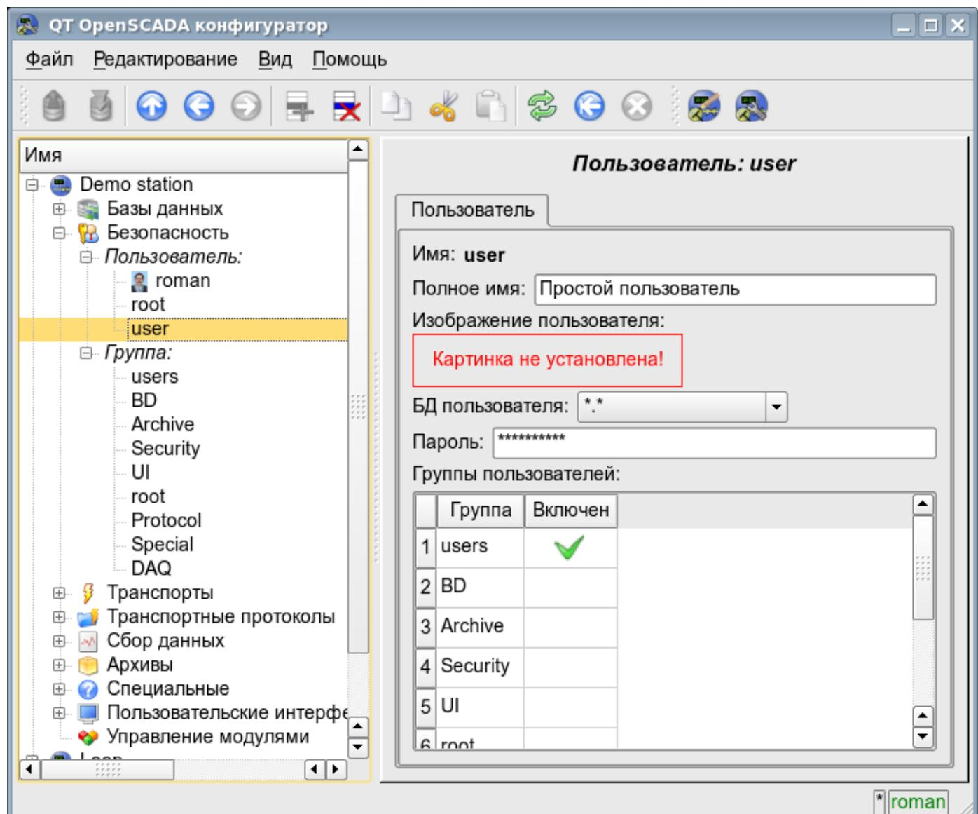
Рис. 22. Вкладка 'Пользователь' страницы пользователя подсистемы 'Безопасность'.
