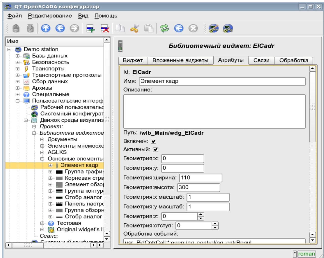
Рис.4.8 Вкладка атрибутов визуальных элементов.
