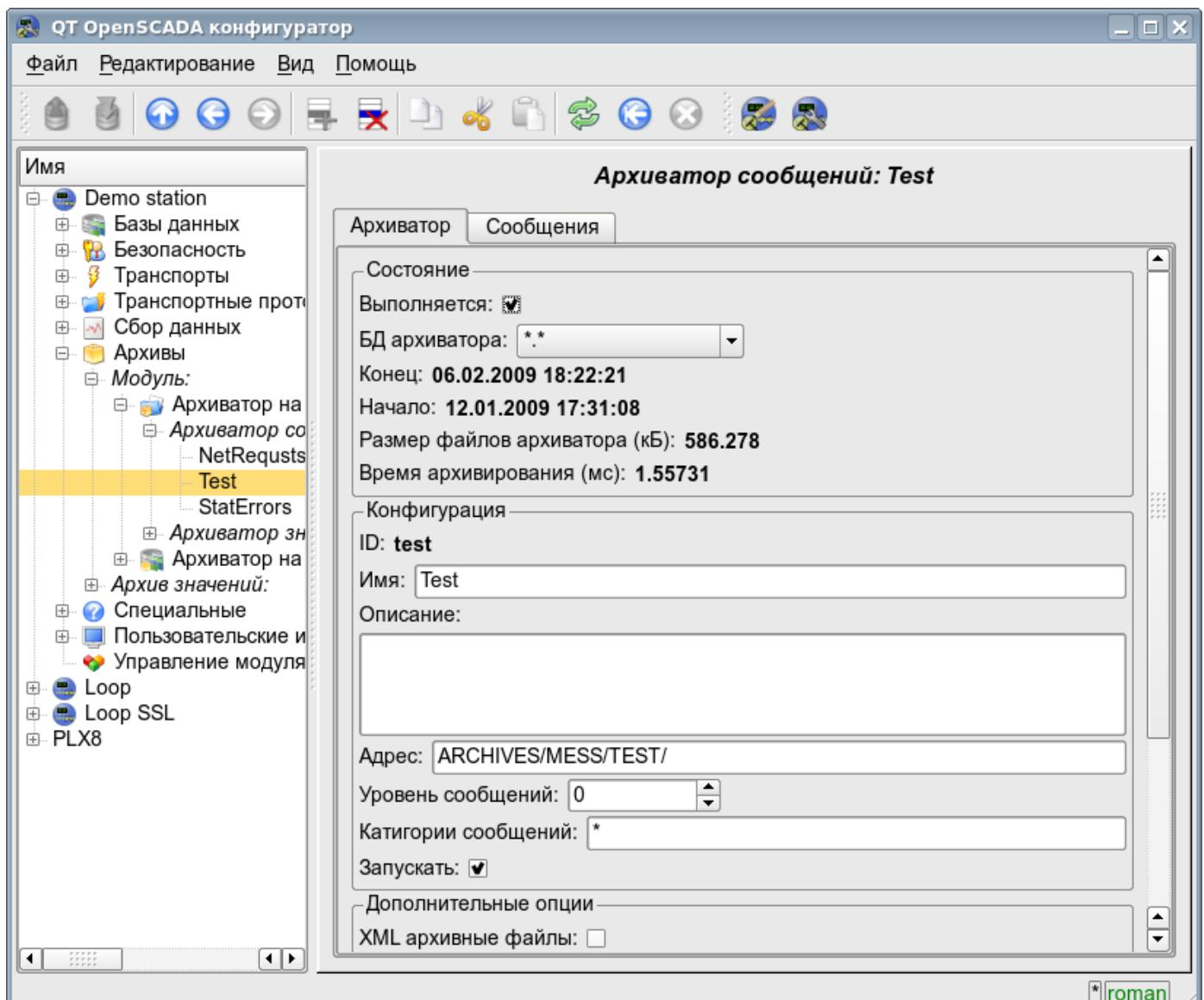
Рис. 51. Главная вкладка конфигурации архиватора сообщений подсистемы 'Архивы'.
