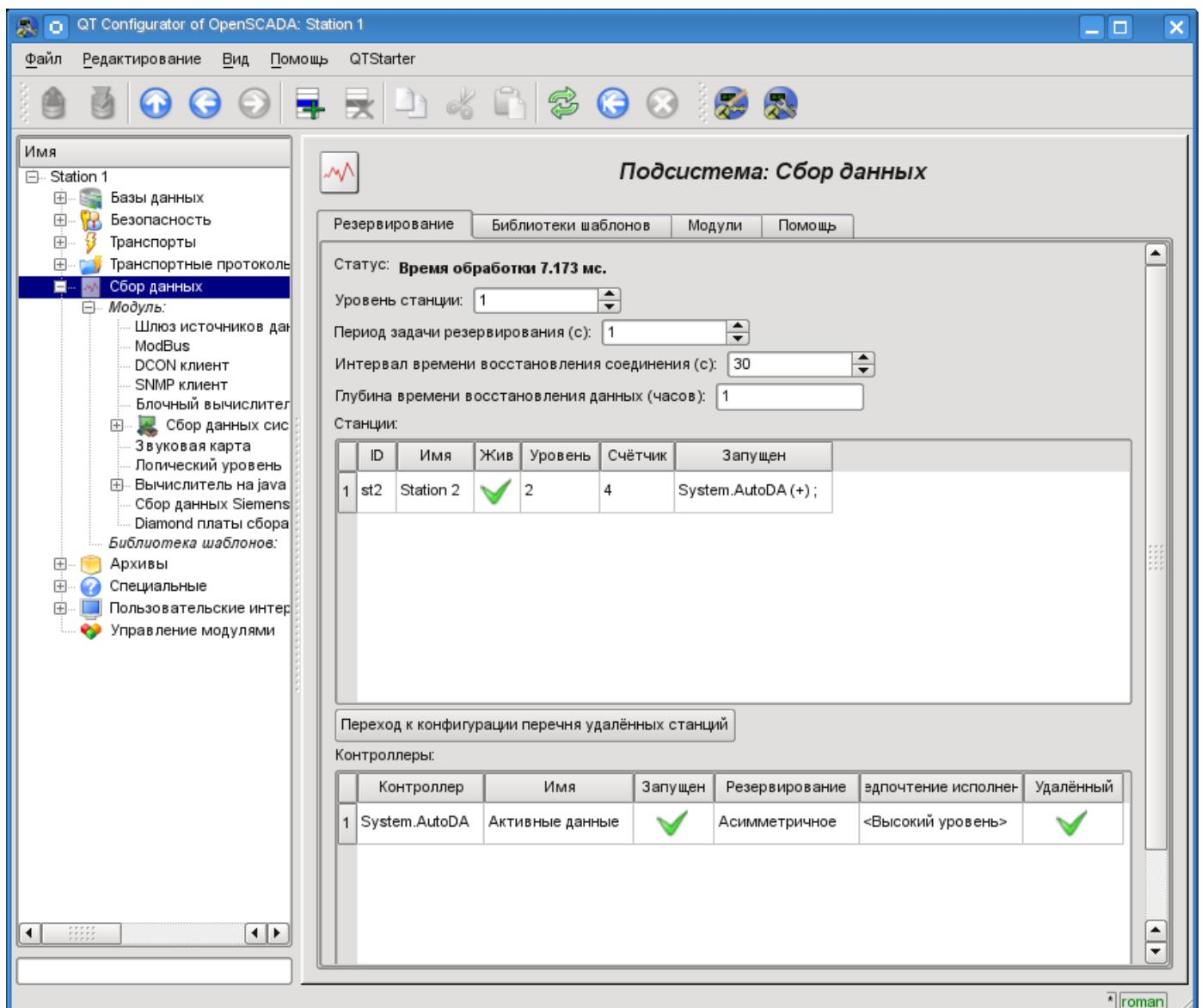
Рис. 31. Вкладка 'Резервирование' подсистемы 'Сбор данных'.
