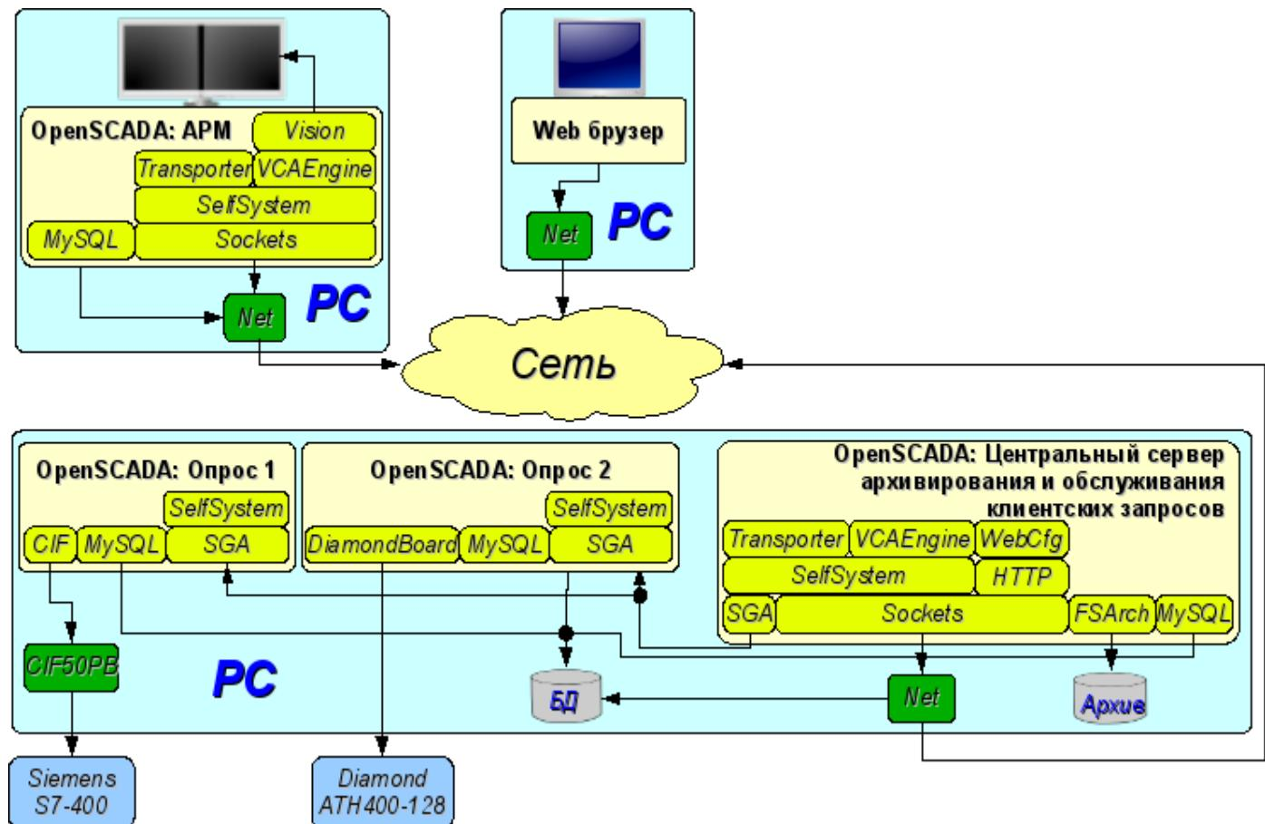
Рис. 10. Устойчивая, распределённая конфигурация
