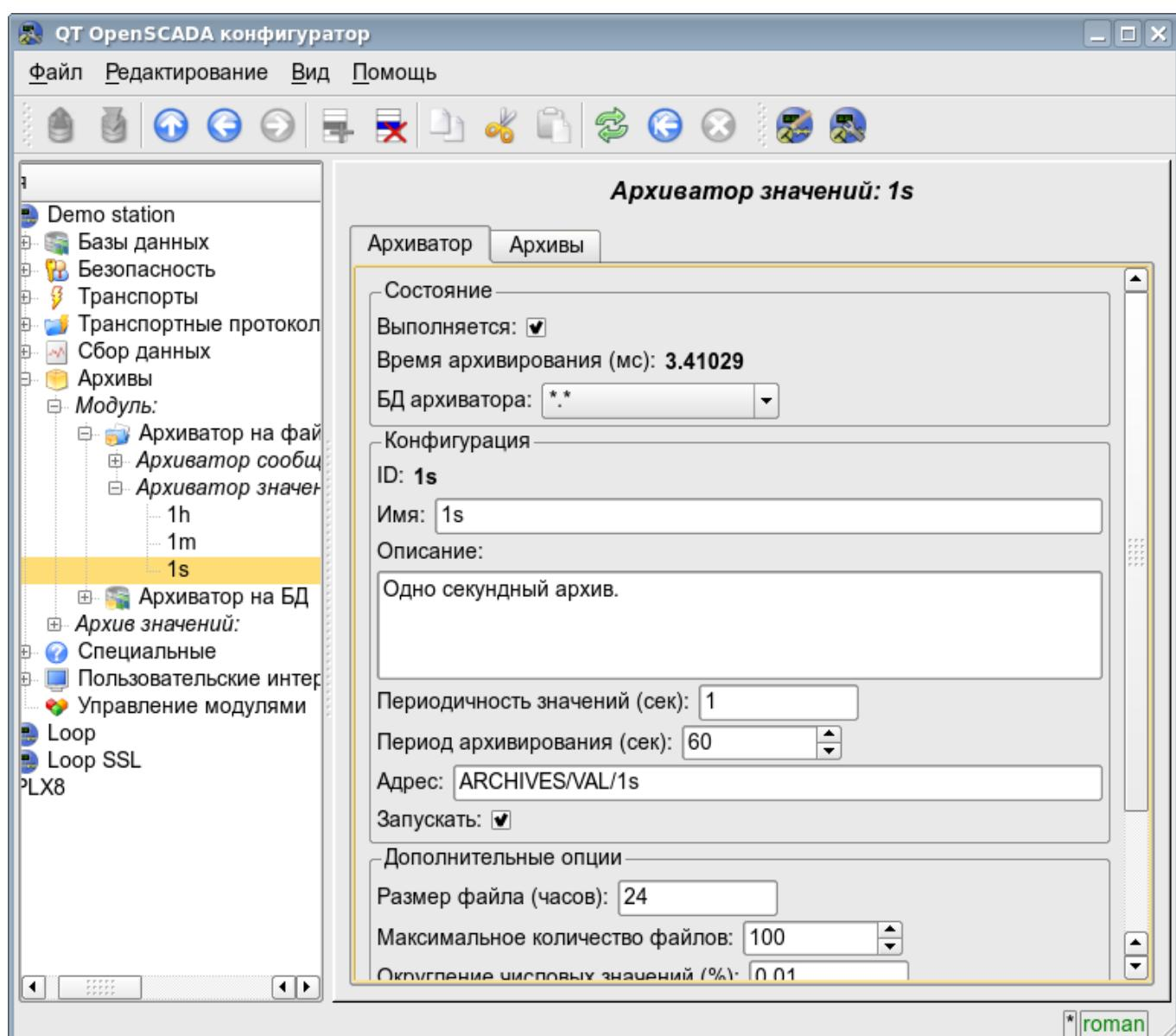
Рис. 53. Главная вкладка конфигурации архиватора значений подсистемы 'Архивы'.
