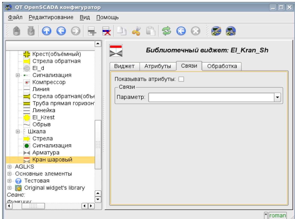
Рис. 3.7.б Вкладка «Связи» страницы конфигурации виджета с групповым назначением атрибутов путём указания только параметра.
